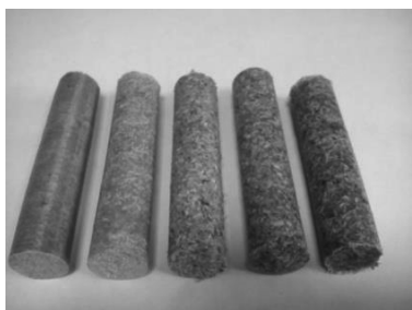
Рис. 4. Образцы композита, полученные с использованием связующего – силикона
