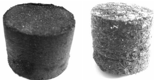
Рис. 2. Образцы композитов, полученные с применением связующего – резины
